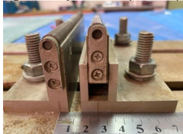
Figura 4 - Ajuste do dispositivo (A); Corpo de prova posicionado na prensa (B).
