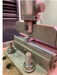
Figura 4 - Ajuste do dispositivo (A); Corpo de prova posicionado na prensa (B).
