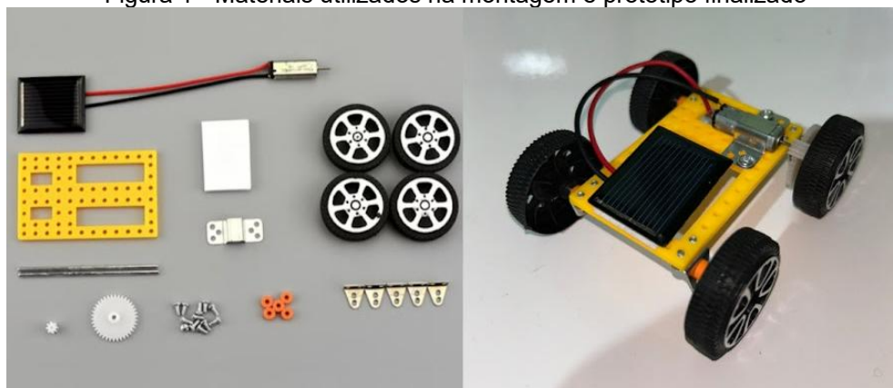
Figura 1 - Materiais utilizados na montagem e protótipo finalizado
