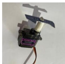
Figura 4 - Hélice com duas extremidades pontiagudas fixada ao eixo giratório do micro servo motor
