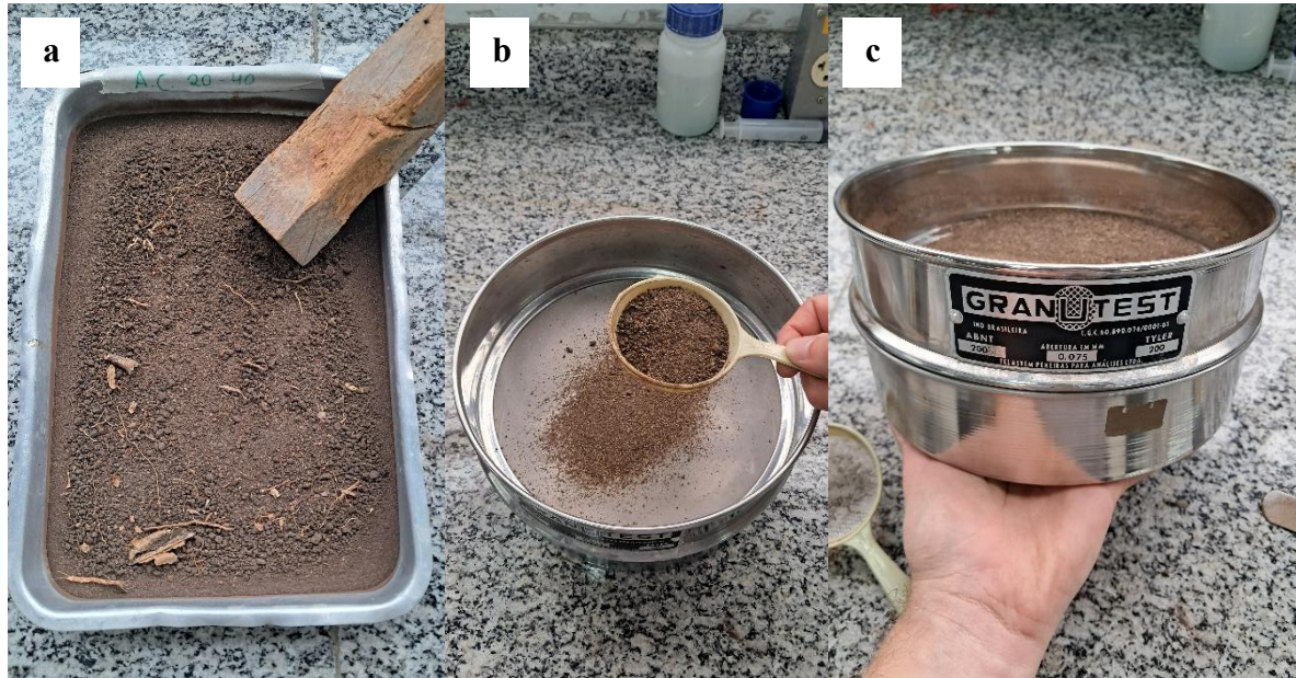
Figura 2 – Tratamento das amostras de solo: a – destorroamento manual do solo; b – processamento em peneira comercial; c – processamento em peneira de 0,075mm de abertura.
