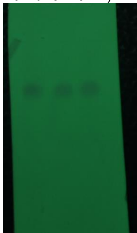
Figura 2 – Cromatografia em camada delgada da fração FC2 (Fase móvel: HEX:AcOEt 8:2 (v/v), revelação em luz UV 254nm)
