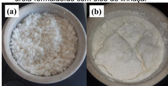
Figura 2 – (a) Microcápsulas de ureia-formaldeído sem óleo de linhaça; (b) Microcápsulas de ureia-formaldeído com óleo de linhaça.
