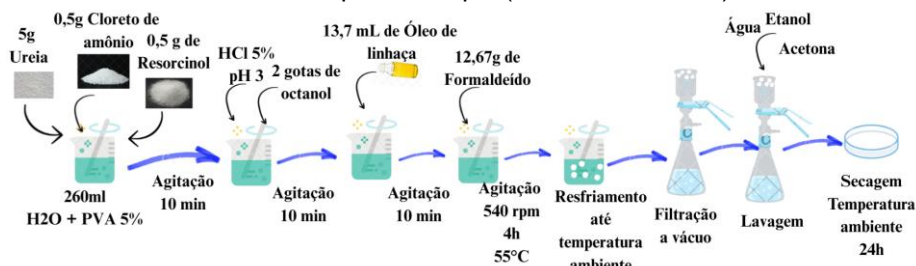
Figura 1 – Rota de síntese de microcápsulas de poli(ureia-formaldeído) contendo óleo de linhaça.
