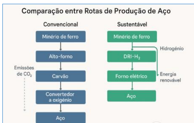
Figura 1 – Comparativo entre as rotas tradicional (alto-forno) e sustentável (DRI-H 2 ) na produção de aço.
