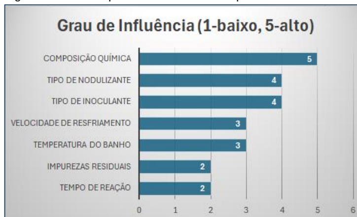
Figura 4 – Fatores que influenciam o desempenho do ferro fundido nodular
