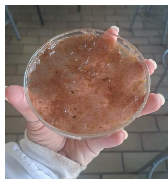
Figura 2 – Filme polimérico após a gelatinização e casting
