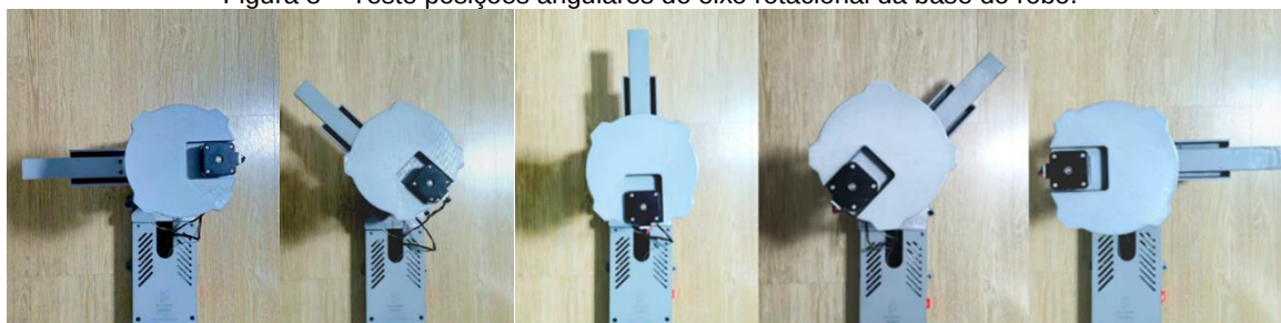
Figura 8 – Teste posições angulares do eixo rotacional da base do robô.
