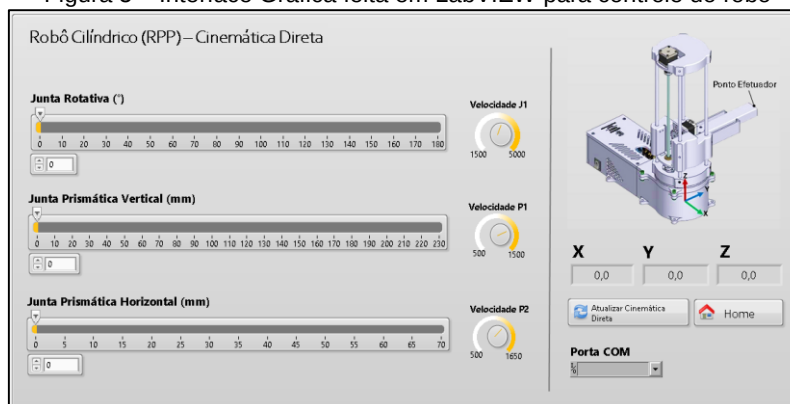
Figura 5 – Interface Gráfica feita em LabVIEW para controle do robô
