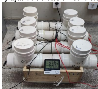
Figura 4 – Equipamento de baixo custo para avaliar a migração de cloretos em concretos.
