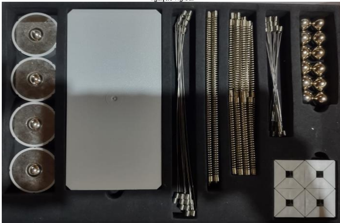
Figura 1 - Materiais utilizados: base; elementos de fixação, elemento esbelto, esferas, molas e elemento de ligação rígida.
