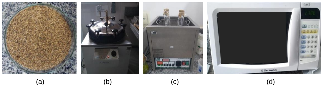
Figura 1 - (a) Casca de café conilon moída e peneirada; (b) autoclave; (c) banho ultrassônico; (d) micro-ondas.
