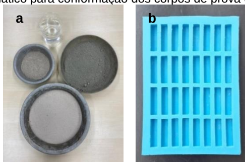
Figura 1 – Materiais utilizados (a) Água, RCO, CP V - ARI e areia natural para preparação das argamassas; e (b) molde prismático para conformação dos corpos de prova em miniatura.
