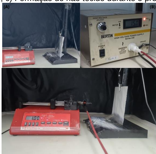
Figura 1: Produção do Não tecido a base de álcool polivinílico. a) Bomba de ejeção e placa coletora. b) Fonte de alta tensão; c) Formação do não tecido durante o processo de eletrofiação
