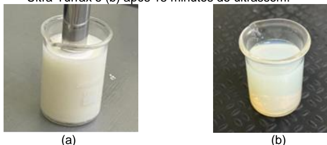
Figura 1 – Mudanças nas características físicas das NE sendo (a) após 5 minutos de homogeneização com Ultra-Turrax e (b) após 15 minutos de ultrassom.
