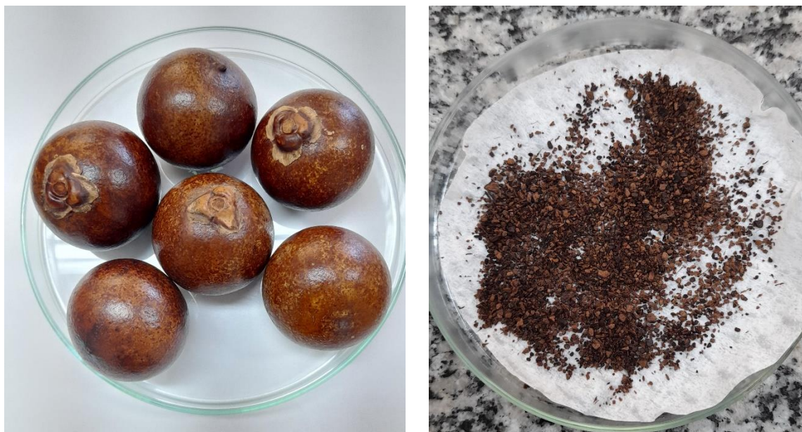
Figura 1 – Fruto da macaúba (ênfase na casca – epicarpo) e as partículas empregadas como suporte na imobilização da lipase Eversa® Transform 2.0 por adsorção física.
