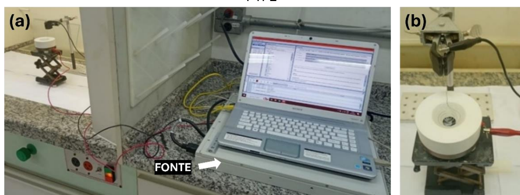
Figura 3 – a) Esquema experimental para produção do Si Poroso a (fonte conectada à cuba; b) cuba de PTFE
