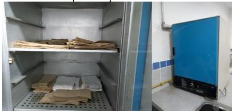
Figura 3 – Estufa utilizada para obtenção da matéria seca das estacas de Piracá.
