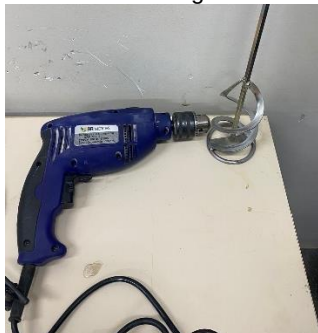
Figura 1 - Furadeira com hélice para misturar os materiais da argamassa.
