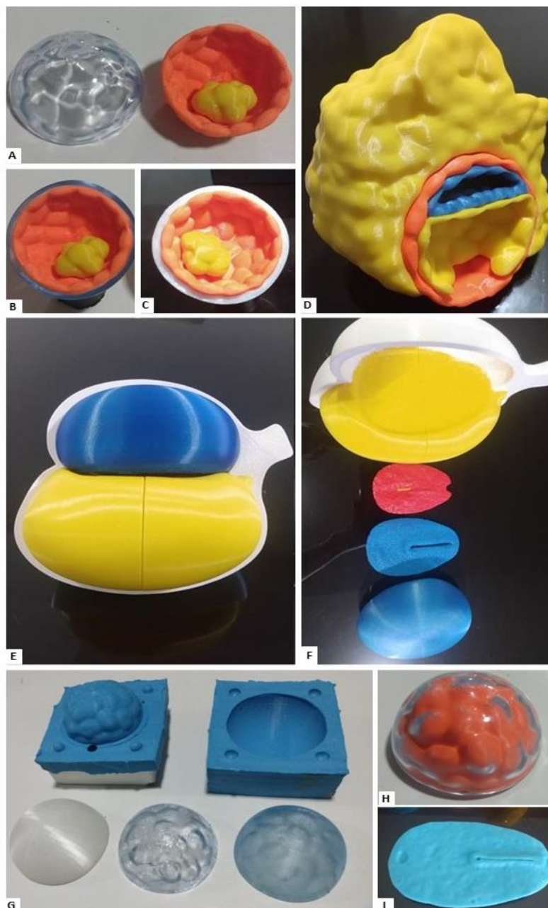
Figura 2 - Modelos didáticos físicos produzidos em impressora 3D a partir dos arquivos .stl gerados no Blender. A-C. Embrião em blástula. D. Embrião em implantação. E-F. Embrião em gástrula montado ( E ) e com suas estruturas desmontadas ( F ). G. Molde de silicone para produção de réplicas da zona pelúcida em resina poliéster (meio) e resina epóxi (à direita) a partir de uma impressão 3D (à esquerda). H. Zona pelúcida em resina. I. Epiblasto confeccionado em biscuit.
