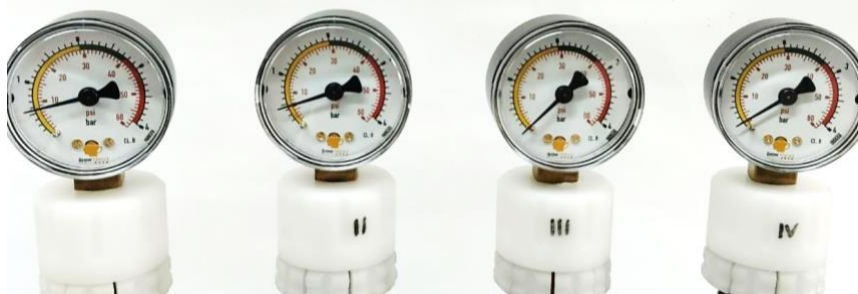
Figura 3 – Experimento de medição pressão com auxílio de manômetro com mesmo tempo de fermentação.
