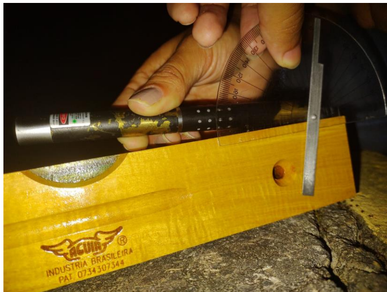
Figura 1 – Medição do ângulo do laser pelo método geométrico.
