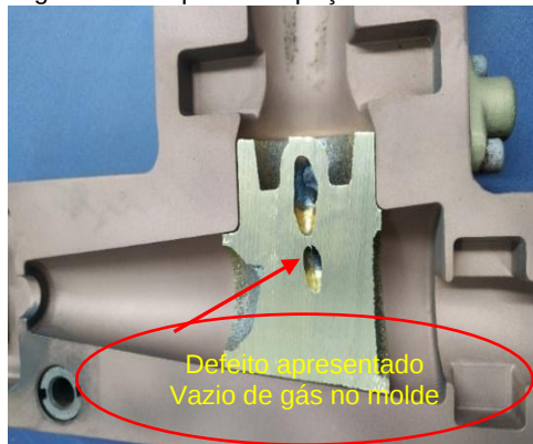
Figura 3 – Coquilha e a peça com defeito.
