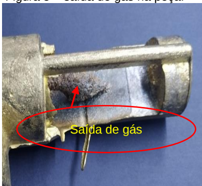
Figura 5 – saída de gás na peça.
