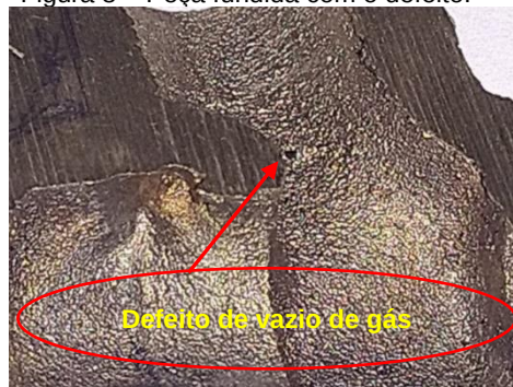
Figura 8 – Peça fundida com o defeito.
