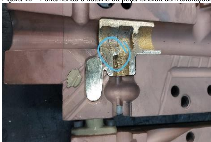
Figura 10 – Ferramental e detalhe da peça fundida com alterações
