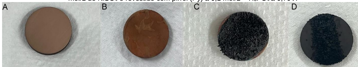
Figura 1 - Disco de cobre antes dos ensaios de OCP e polarização. (A) - Disco de cobre (99%). (B) - Disco de cobre com pré-tratamento com 0,2 \text{ mol/L} de \text{NiSO}_4 . (C) - Disco de cobre com pré-tratamento com 0,2 \text{ mol/L} de \text{NiSO}_4 e revestido com pirrol (Py) a 0,1 \text{ mol/L} + \text{H}_3\text{PO}_4 a 0,65\text{V} . (D) - Disco de cobre com pré-tratamento com 0,2 \text{ mol/L} de \text{NiSO}_4 e revestido com pirrol (Py) a 0,1 \text{ mol/L} + \text{H}_3\text{PO}_4 a 0,70\text{V} .
