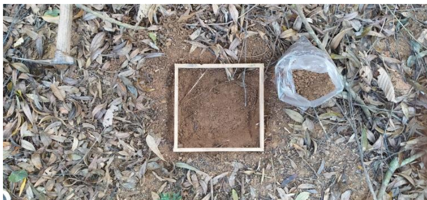
Figura 1 – Demonstração da utilização do gabarito de madeira (25 x 25 x 8 cm) para coleta de banco de sementes na camada superficial do solo com a remoção da serapilheira
