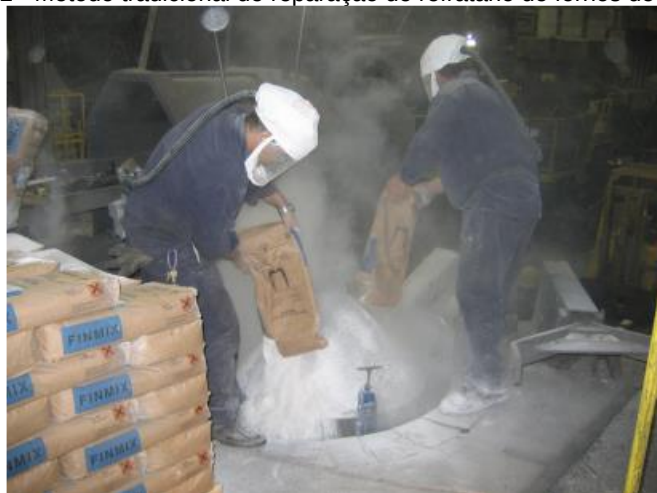
Figura 2 - Método tradicional de reparação de refratário de fornos de indução.
