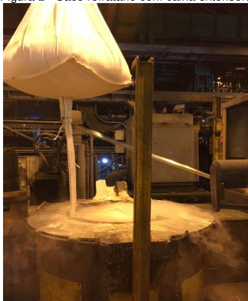
Figura 2 - Saco refratário com calha extensora.
