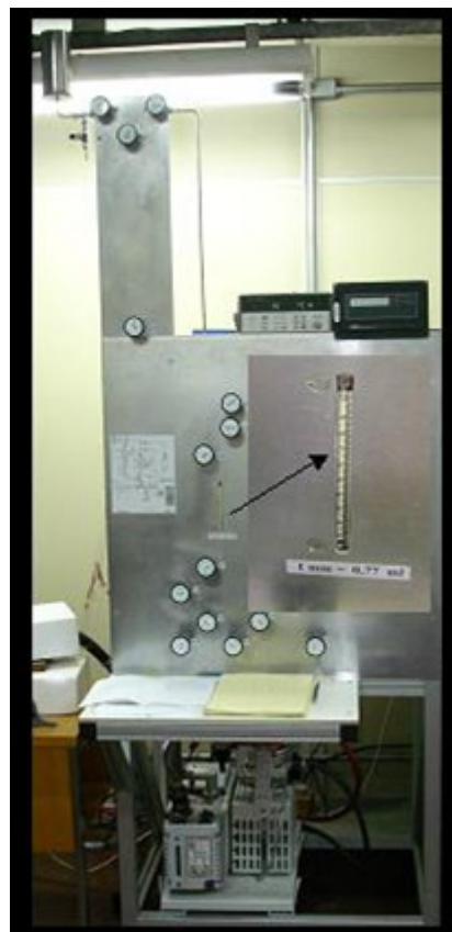
Figura 5 – Estação de Carga para o Carregamento dos Tubos
