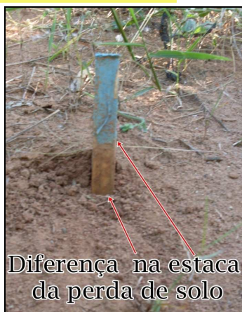
Figura 4 – Detalhe do desgaste superficial verificado em um pino (estaca) do T3 – Pomar mantido todo capinado.
