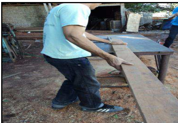
Figura 8 - Operadores da serra circular expostos as partes vivas do motor sem nenhum EPI de segurança. (EC-C)
