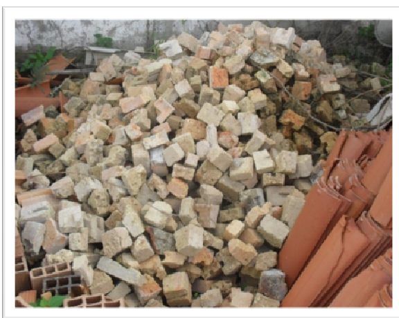
Figura 5 - Perda de tijolos cerâmicos.
