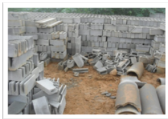
Figura 3 - Perda de tijolos de concreto.
