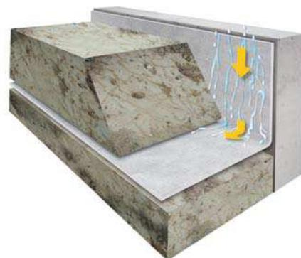
Figura 11 – Função de drenagem transversal. (Elephant Nonwovens Portugal, Ltda).
