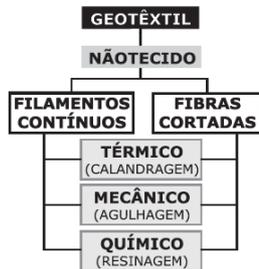
Figura 1 – Exemplo do Processo de Fabricação (ABINT, 2001)
