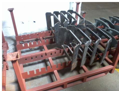
Figura 5 – rack do estribo da máquina R-954.
