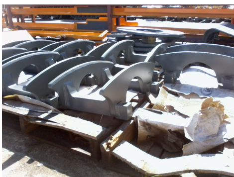
Figura 2 – guia de corrente da máquina R-944, armazenada em pallets .
