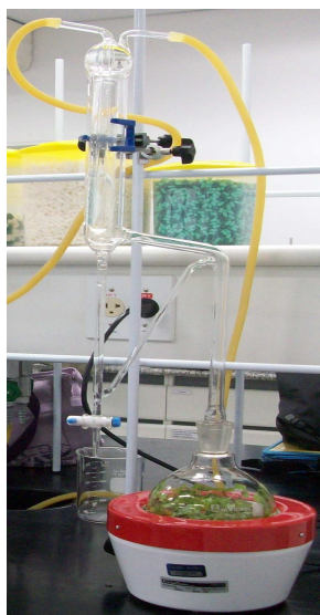
Figura 1: Extração do óleo essencial de citronela utilizando-se o aparelho de Clevenger.
