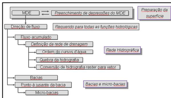
Figura 2 - Fluxograma das operações que envolveram a análise hidrológica realizada na bacia hidrográfica do ribeirão Jerusalém, ES.
