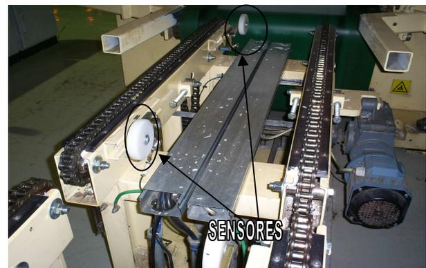
Figura 8 – Sensores indutivos mostram a posição dos fardos
