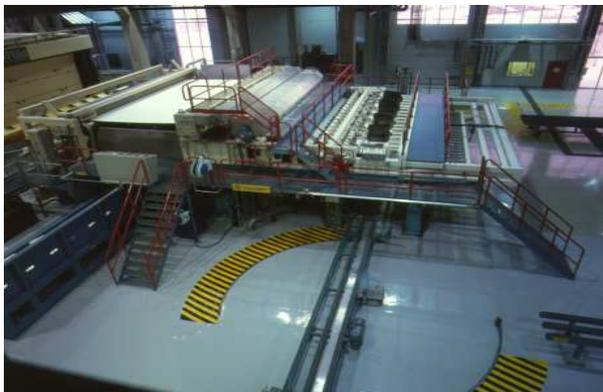
Figura 3 - Fotografia da seção de saída da cortadeira para a linha de enfardamento no piso de fabricação.
