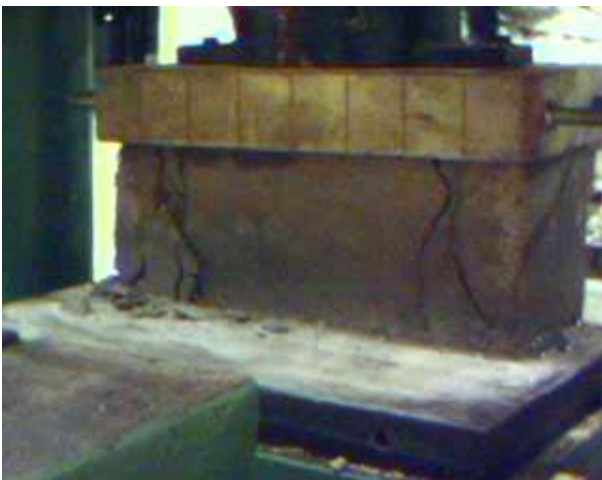
Figura 4.0 – Ruptura Bloco Pet
