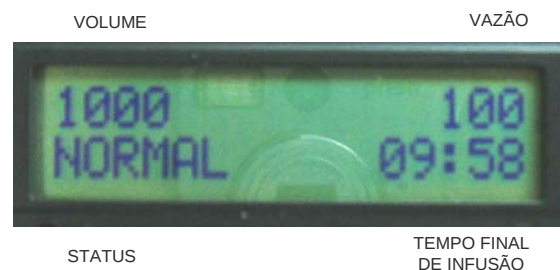
Figura 4 – Painel (LCD) da bomba de infusão de baixo custo em funcionamento.
