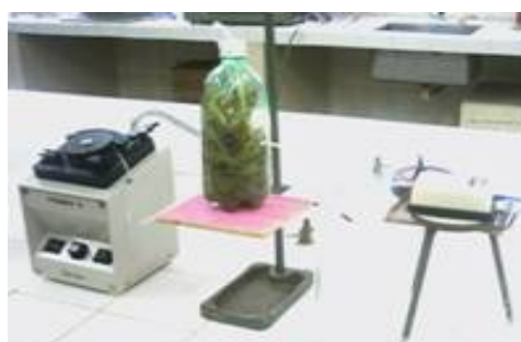
Figura 1: Foto do Sistema do Processo Contínuo para a Fermentação Acética. Da esquerda para a Direita: Bomba Peristáltica, Reator Contínuo e Bomba de Ar.
