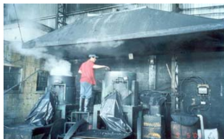
Figura 8 – Falta do uso de EPI
