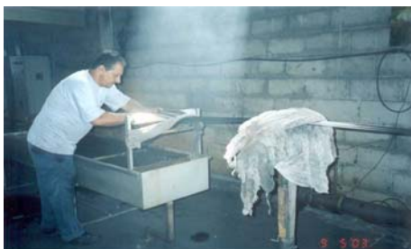
Figura 7 – Falta do uso de EPI
