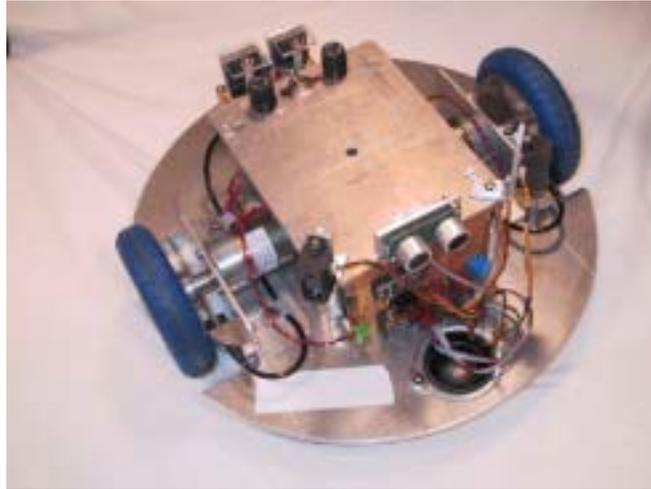
figura 1 – Plataforma do robô móvel do NEAC/UNIDERP.
