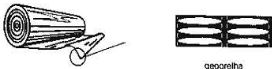
Figura 1: Detalhes da Geogrelha.
