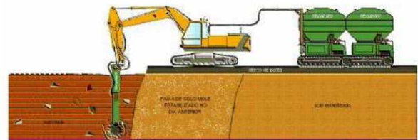
Figura 5: Detalhe esquemático do Sistema STABTEC (SILVA; BATISTA; SANTOS; BARROS, 2010).
