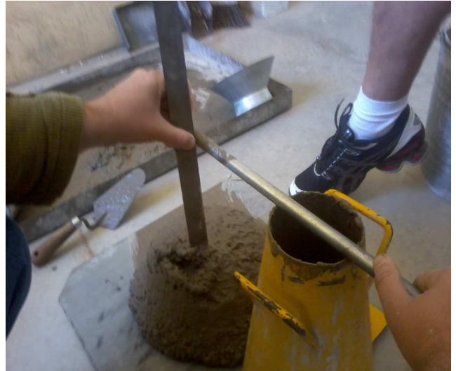
Foto 5 teste tronco de cone Fonte: os autores
