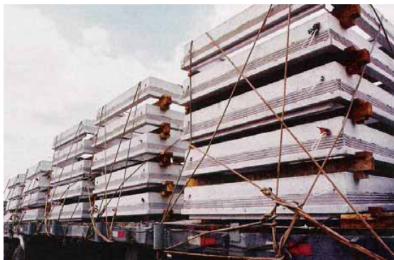
Figura 6 - Contramarcos de janelas produzidos com RCD e empregados na obra do condomínio Villagio Maia (CAPELLO, 2006)
