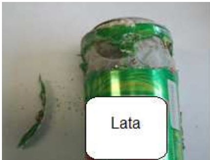
Figura 1. Exterior da lata na solução básica.
