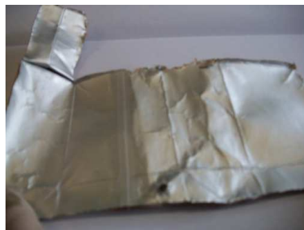
Figura 6. Interior da caixa na solução ácida.
