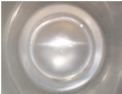
Figura 2. Interior da lata na solução neutra.
