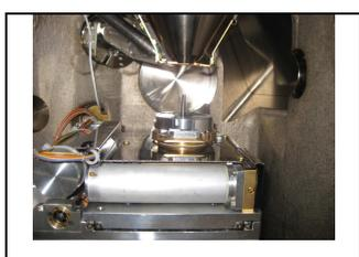
Figura 6 – Mostra a amostra do pino de titânio no interior da câmara do MEV.
