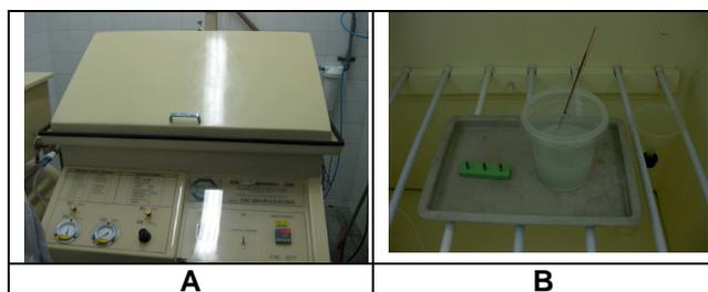
Figura 5 – Mostra a câmara de Salt Spray (A) e o detalhe da exposição dos corpos-de-prova no interior da câmara (B).
