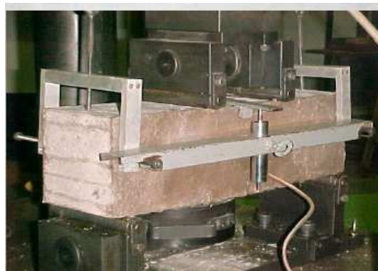
Figura 13- Ensaio de tração na flexão.
