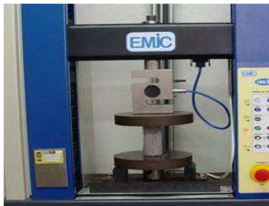
Figura 12- Ensaio de compressão axial.
