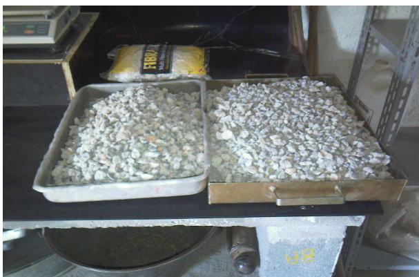
Figura 2 - Agregado graúdo reciclado
