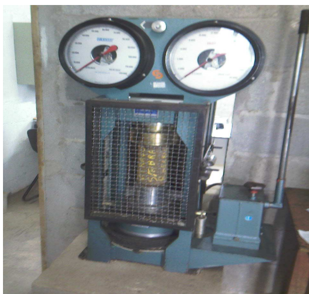
A figura 4 – Prensa - Ensaio mecânicos de resistência à compressão.
