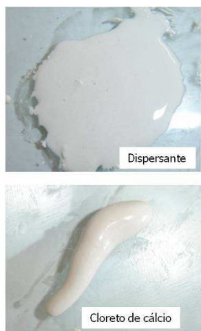
Figura 1: Suspensões de CAC na presença de aditivos: (a) dispersante e (b) cloreto de cálcio, mostrando melhoramentos na viscosidade e plasticidade.
